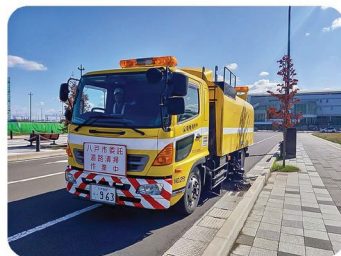
ロードスーパーでの路面清掃
