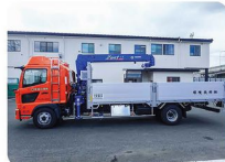
重量物の扱いに便利な移動式クレーン車
